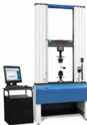
Рис. 7. Универсальная испытательная машина Instron
