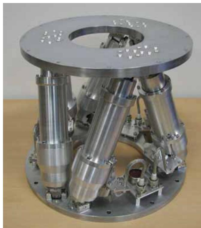
Рис. 1. Манипулятор «Гексапод-ПМ-мкм-3» ООО «Прикладная механика»
