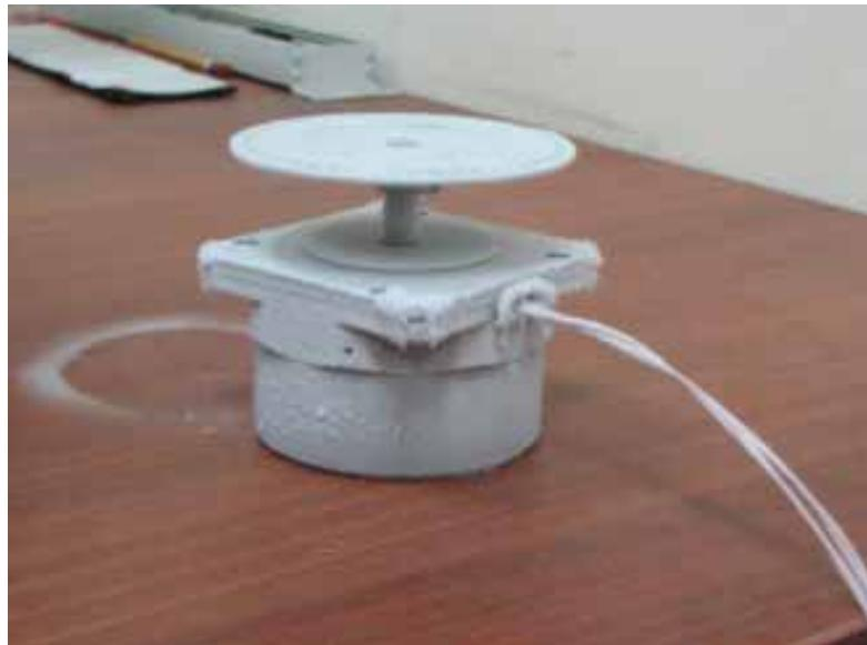
Рис. 3. Двигатель в процессе обледенения после извлечения из емкости с жидким азотом
