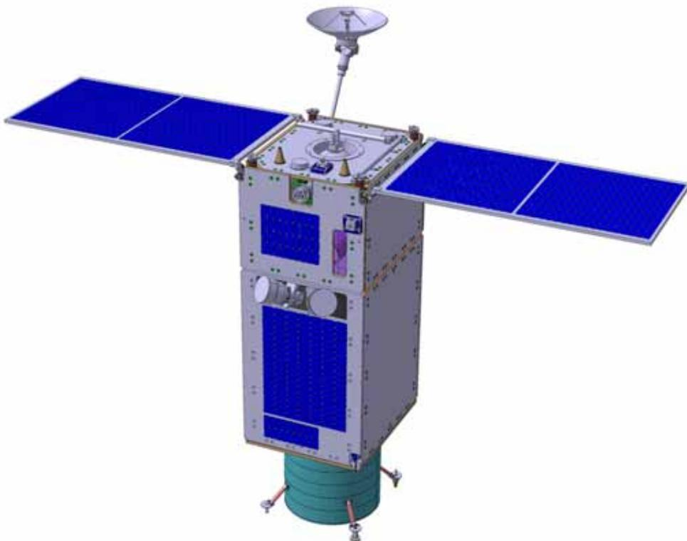
Рис. 3. Космическая платформа НТ-400 в рабочем положении
