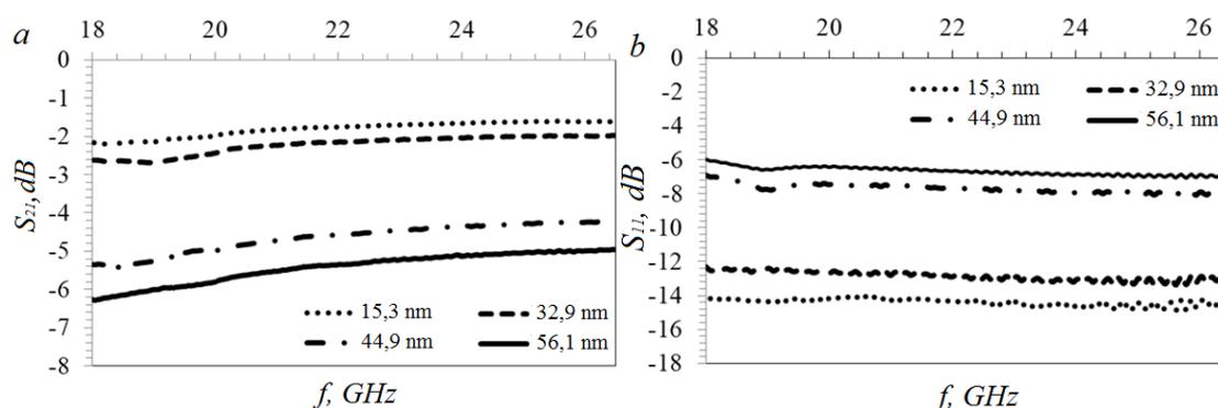
Fig. 5. Spectral dependences of parameters  $S_{21}$  (a) and  $S_{11}$  (b) for SWCNT films of various thicknessesРис. 5. Спектральные зависимости параметров  $S_{21}$  (a) и  $S_{11}$  (b) для пленок ОУНТ различной толщины
