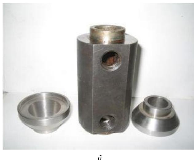
Рис. 1. Устройство для исследования вязких и пластичных свойств: а – схема; б – корпус устройства с двумя переходниками
